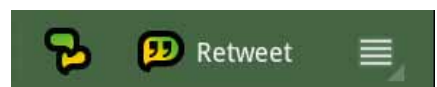
Abbildung 5: Ausschnitt der ActionBar mit direkt zugänglichen Menü-Einträgen und dem Menü-Indikator auf „Honeycomb“
